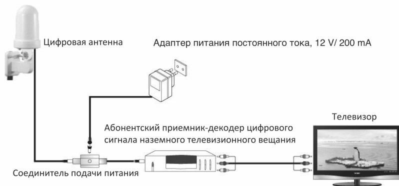
Порядок подсоединения: подсоединение с использованием адаптера питания 12V/ 200mA (рис. 1)
