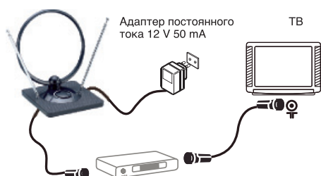
(Рис. 2). Прямое подключение к телевизионной приставке
